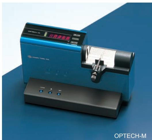
OPTECH-Mは、プリント基板用超硬ドリルのための光学式非接触型外径測定器です。接触型測定器によるドリルの欠けの問題を解消しました。また、OPTECH-MAは、奇数刃／偶数刃のルータ、ドリル等の刃径を測定することが可能です。さらに、インチ対応等の特殊品もご用意できます。
