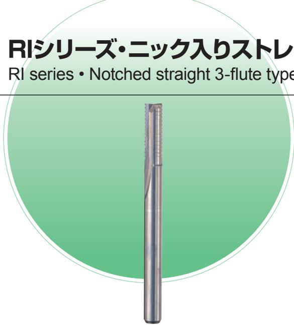
ストレートの3枚刃タイプで切刃にニックが入っており、切粉を分割します。一般的なガラス・エポキシ系基板の他に非鉄金属等の外形仕上加工に適しており、良好な加工精度が得られます。
