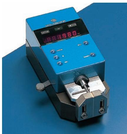
弊社製SF級クロスローラーガイド付きスピンドルに、精密ガラススケールを使用した高精度のデジタルマイクロメーターです。レバー操作で測定子を開き、その間に被測定物を挟み込むことにより一定の測定力で測定を行い、その値をデジタル表示します。
