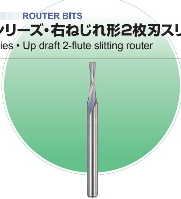
RSシリーズと逆ねじれの右ねじれ刃を持ったスリット加工用で、切粉は上方に排出されますので吸入装置の付いたNC加工機に適しています。
