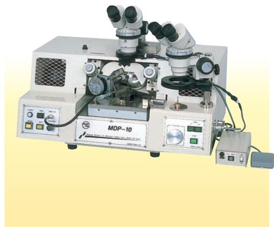
ドリルポインターMDP-10型は、MDPシリーズの中で最も新しいタイプで $\phi 1.0\text{mm}$ 以下の小径の電子回路基板用超硬ドリルの先端研削加工に最適です。
