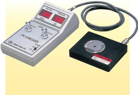
PVチェッカーは、プレッシャフットの押圧力と吸引圧力、及びブッシュの当たり方を測定または観察する為の測定器です。PCBドリルでのより高品質な穴明作業を行うために、穴明機自体の動作状態の管理、製品の品質管理には必需品です。
