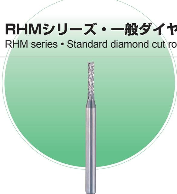
左ねじれの切刃で切粉が下方に排出され、基板を下に押し付ける力が働くため、表面のバリを小さく抑えることができます。また、集塵装置がスピンドルに対し基板の反対側に位置するような基板分割機での使用においては、良好な切粉排出が可能となります。
