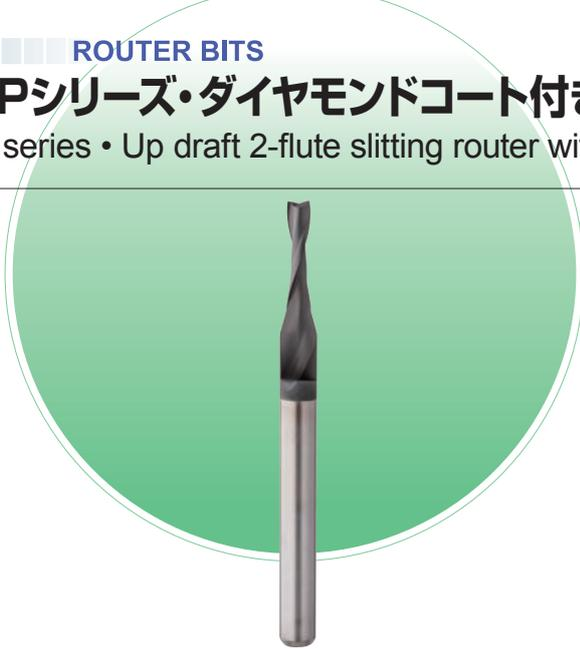
RP(右ねじれ 2枚刃スリッティングルーター)をベースに、高硬度で優れた耐摩耗性・密着性を有するダイヤモンドコーティング処理を行いました。切刃摩耗が起こりやすい絶縁層付きメタルベース基板などの加工に最適です。
