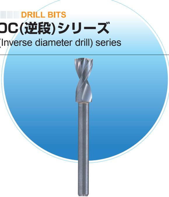
チップブレーカーによりドリルビットへの切粉巻き付きを抑え、独自のシンニング加工により、スラスト荷重を大幅に改善し高速スピンドルへの負荷を軽減しました。さらに再研磨後も同じ刃形が得られるため、性能が変わりません。
