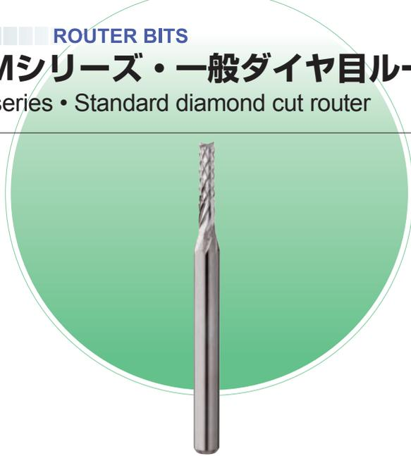
右ねじれの切刃で切粉が上方に排出され、きれいな加工面が得られます。吸入装置の付いたNC加工機に適します。
